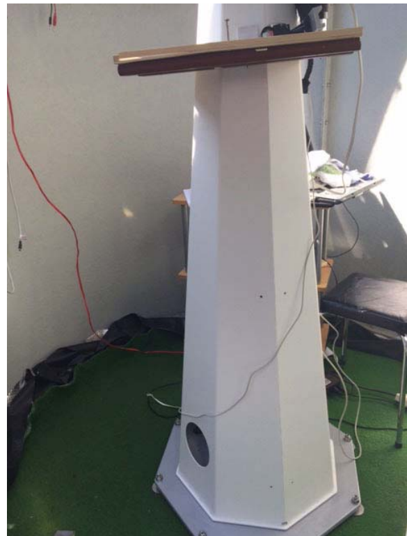
Celestron C14 auf EQ8; Sternwartensäule P200-140 auf Basisplatte verschraubt; auf Dachterrasse unter Baader Kuppel stehend, der Boden sollte nicht angebohrt werden. Herr S aus G. schreibt: „... was Sie da geliefert haben ist schlicht optimal. Sie haben mich engagiert beraten und haben eine sehr gute Lösung für meine speziellen Bedingungen gesucht und gefunden; ich hätte das so nicht für möglich gehalten!“
