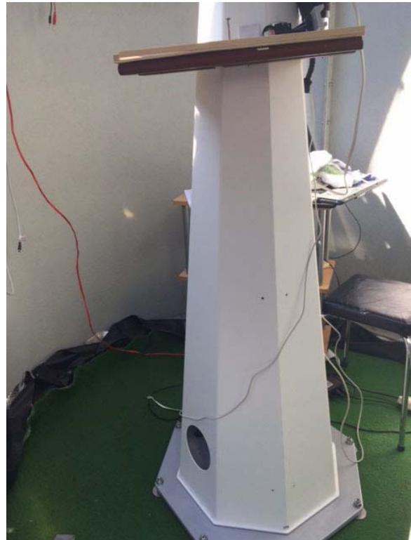
Celestron C14 auf EQ8; Sternwartensäule P200-140 auf Basisplatte verschraubt; auf Dachterrasse unter Baader Kuppel stehend, der Boden sollte nicht angebohrt werden. Herr S aus G. schreibt: „... was Sie da geliefert haben ist schlicht optimal. Sie haben mich engagiert beraten und haben eine sehr gute Lösung für meine speziellen Bedingungen gesucht und gefunden; ich hätte das so nicht für möglich gehalten!“
