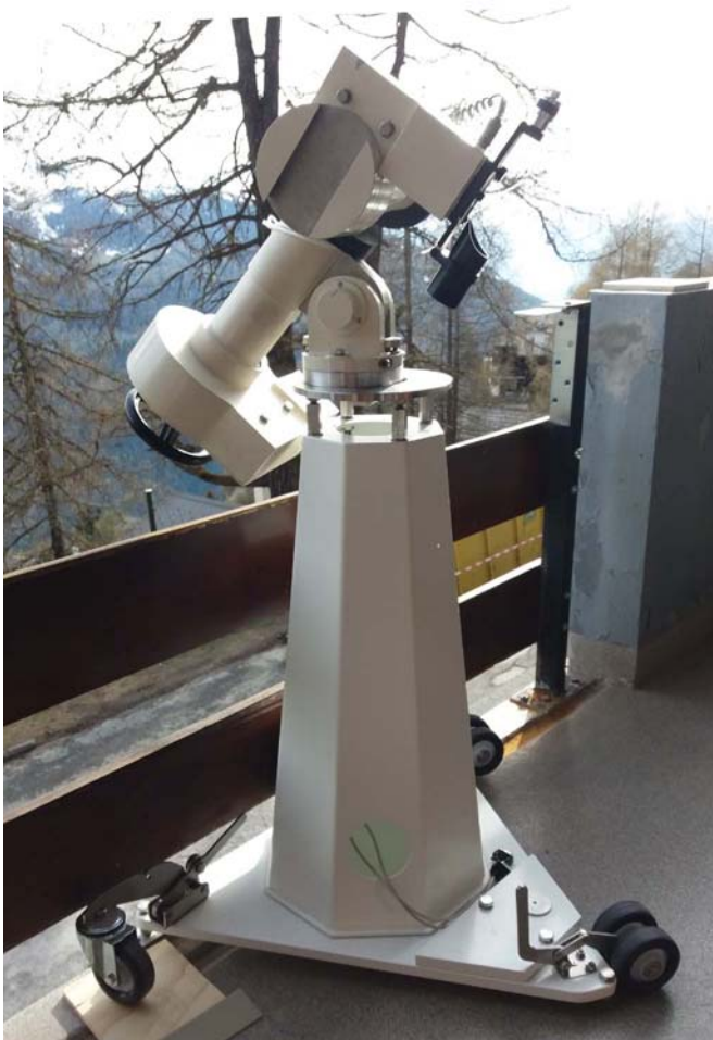
P200 auf Rollbasis, mobil auch unter sehr beengten Platzverhältnissen, Montierung von Eckhard Alt
