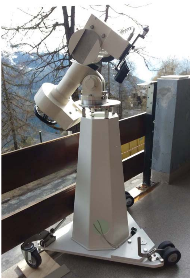
P200 auf Rollbasis, mobil auch unter sehr beengten Platzverhältnissen, Montierung von Eckhard Alt.
