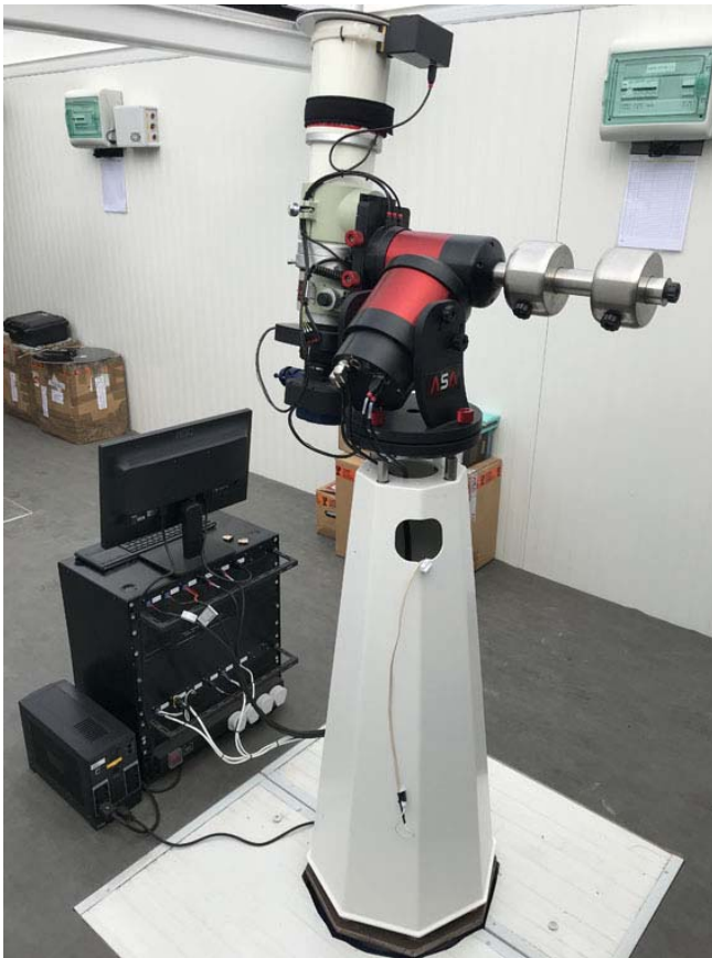
Sternwartensäule P200 mit ASA DDM60 und DDM85 auf einer spanischen Beobachtungsstation.
